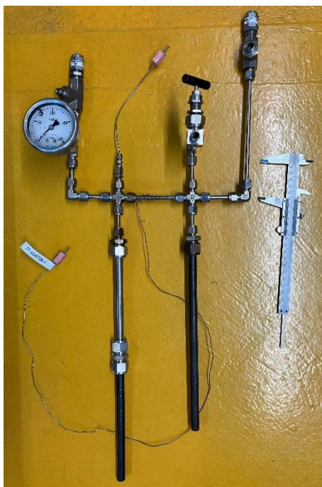
Figuur 3-2 Batch-vergassingsreactor van SCW Systems. Deze reactor is gebruikt voor de batch SKWV-experimenten.
